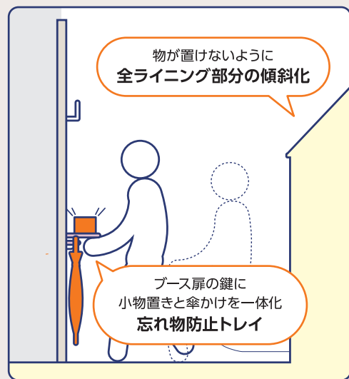
忘れ物対策 トイレブース内
